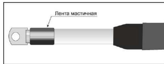
**14.** Надвинуть на жилу термоусаживаемую трубку, с заходом конус корпуса МСХ 50-60мм. Произвести термоусадку трубы мягким пламенем горелки от конуса корпуса МСХ, не допуская образования складок и вздутий. Следует избегать остроконечного синего пламени. Постоянно перемещайте пламя во избежание пережога материала.
