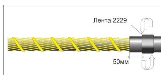
4. Для кабеля с проволочным экраном после удаления оболочки необходимо отогнуть медные проволоки экрана и аккуратно вдавить их в мастичную ленту так, чтобы они не пересекались (экран зафиксировать ПВХ лентой).
