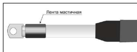
**14.** Надвинуть на жилу термоусаживаемую трубку, с заходом конуса корпуса МСХ 50-60мм. Произвести термоусадку трубки мягким пламенем горелки от конуса корпуса МСХ, не допуская образования складок и вздутий. Следует избегать остроконечного синего пламени. Постоянно перемещайте пламя во избежание пережога материала.
