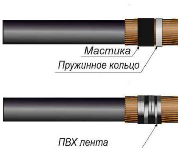
**5. Отрезать кабель на длину  $D + C + 5$  мм от экранированных проволок как указано на рисунке.**
