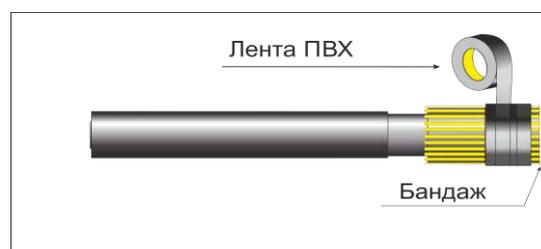
**10.** Произвести намотку медной сетки. Намотку сетки производить с заходом на медный экран, полупроводящий слой и броню кабеля, не заходя на ТУТ усаженную на жилу. Сетка должна полностью закрывать медный экран на расстоянии 60мм. Сетка наматывается с 50% перекрытием витков с небольшим натяжением.
