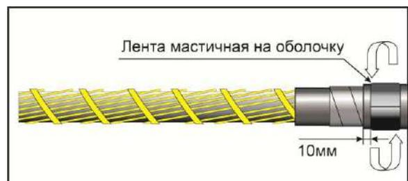
**4. Вариант 1.** Для кабеля с проволочным экраном после удаления оболочки необходимо отогнуть проволоки экрана и аккуратно вдавить их в ленту мастичную так, чтобы они не пересекались (экран зафиксировать ПВХ лентой).
