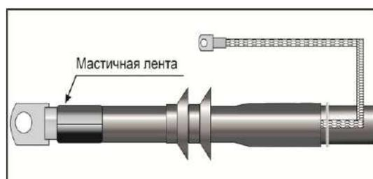
**17.** Надвинуть на наконечник красную термоусаживаемую трубку, расположив её таким образом, чтобы она после усадки закрывала мастичную ленту намотанную на наконечнике. Произвести термоусадку трубки мягким пламенем горелки от центра к краям, не допуская образования складок и вздутий, до выделения клеевого слоя на краю трубы. Следует избегать остроконечного синего пламени. Постоянно перемещайте пламя во избежание пережога материала.
