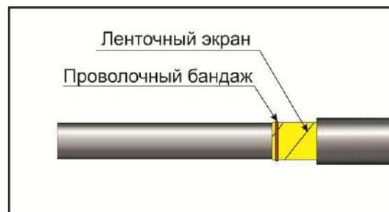
**5.** По размеру указанному на рисунке удалить полупроводящий слой с жилы кабеля, оставив 40мм.
