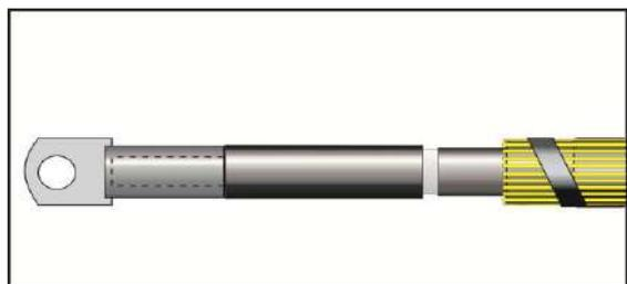
**Б. Механический болтовой наконечник.**
