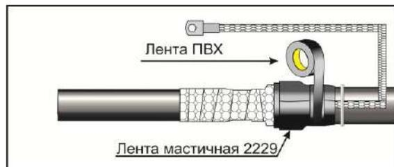
В месте расположения блокиратора провода заземления мастику прижать с помощью 2-3 слоев ПВХ ленты. Ленту наносить с натяжением.
