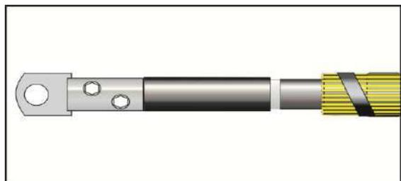
При использовании наконечников с тремя болтами производить затягивание и срыв болтов в последовательности, указанной на рисунке.
