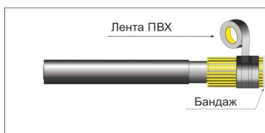
10. Произвести намотку медной сетки. Намотку сетки производить с заходом на медный экран и полупроводящий слой кабеля, не заходя на ТУТ усаженную на жилу. Сетка должна полностью закрывать медный экран на расстоянии 40мм. Сетка наматывается с 50% перекрытием витков с небольшим натяжением.
