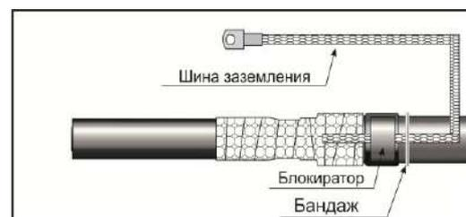
кабеля (или поверх мастичной ленты 2229 установленной на оболочке кабеля для кабеля с проволочным экраном). Зафиксировать провод заземления на оболочке кабеля при помощи банджа из медной лужёной проволоки входящей в комплект. Зафиксировать его поверх медной сетки на медном экране кабеля пружинными кольцом. Легкими ударами молотка произвести обстукивание пружинного кольца. Пружинное кольцо сверху покрыть 2 слоями ПВХ ленты.
