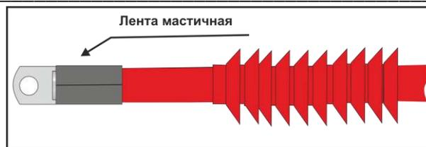
**19.** Продеть поверх мастичной ленты наконечника одну термоусаживаемую трубку и усадить его до выделения клеевого слоя на краях. При усадке следует следить за положением трубки – она не должна сползать с наконечника.
