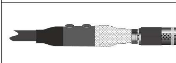
**13.** Надвинуть на жилу термоусаживаемую трубку большего диаметра на корешок кабеля. Произвести термоусадку трубки мягким пламенем горелки как показано на рисунке, не допуская образования складок и вздутий. Следует избегать остроконечного синего пламени. Постоянно перемещайте пламя во избежание пережога материала.
