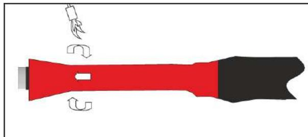
**15.** Одеть на жилу изоляторы, расположив первый на расстоянии 5мм от торца конуса корпуса МСХ. Произвести термоусадку изоляторов на жилу, усадку производить, не допуская образования складок и вздутий, до выделения клеевого слоя на краю трубок.
