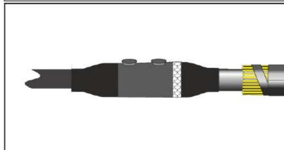
10. Обмотать лентой 13 с заходом на 20мм на полупроводящий слой кабеля, ТХУ (Трубка холодной усадки) корпуса МСХ до уже нанесённой медной сетки на корпусе МСХ с небольшим натяжением, с 50% перекрытием.
