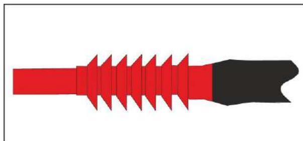
**16.** Удалить изоляцию жилы кабеля на длину равную глубине хвостовой части наконечника.
