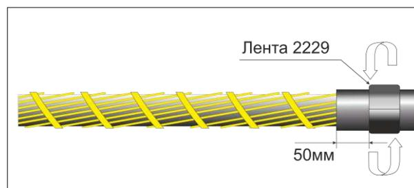
4. **Для кабеля с проволочным экраном** после удаления оболочки необходимо отогнуть медные проволоки экрана и аккуратно вдавить их в мастичную ленту так, чтобы они не пересекались (экран зафиксировать ПВХ лентой). **Медные проволоки не обрезаются.**
