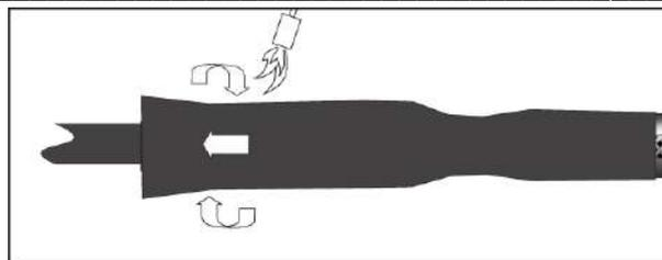
**14.** Надвинуть на жилу термоусаживаемую трубку, с заходом конус корпуса МСХ 10мм. Произвести термоусадку трубки мягким пламенем горелки от конуса корпуса МСХ, не допуская образования складок и вздутий. Следует избегать остроконечного синего пламени. Постоянно перемещайте пламя во избежание пережога материала.
