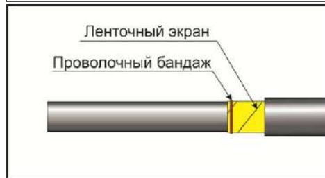
5. По размеру указанному на рисунке удалить полупроводящий слой с жилы кабеля, оставив 200мм. Удаление полупроводящего слоя производить специальным инструментом, не допуская остатков полупроводящего слоя на поверхности изоляции. При остатке полупроводящего слоя на поверхности изоляции или образования неровностей изоляции зачистить с помощью наждачной бумаги.
