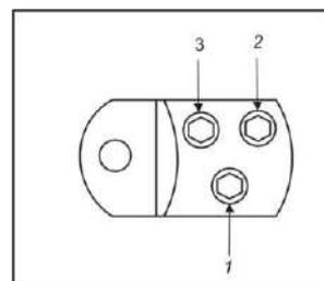
**18.** Удалить упаковочную бумагу с одной из сторон пластины мастичной ленты. Произвести намотку пластины таким образом, чтобы мастика полностью закрывала отверстия от болтов (или пресса), и образовывала плавный переход от диаметра наконечника до диаметра жилы. По ходу намотки удалить упаковочную бумагу со второй стороны пластины.
