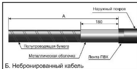
**4.** Оборвать полупроводящую бумагу на расстоянии 20 мм от края оболочки до поясной изоляции при помощи кабельной стяжки или нитки х/б.
