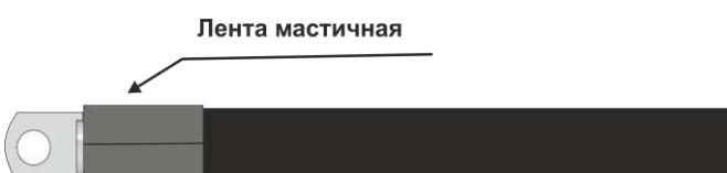
**18. Надвинуть на жилу термоусаживаемую трубку, с заходом на конус корпуса МСХ 50-60мм.** Произвести термоусадку трубы мягким пламенем горелки от конуса корпуса МСХ, не допуская образования складок и вздутий. Следует избегать остроконечного синего пламени. Постоянно перемещайте пламя во избежание пережога материала. После усадки трубы, выступающие края обрезать.
