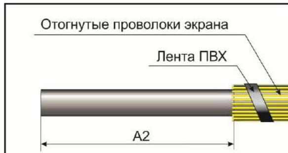
**Вариант 2б.** 2-я сторона кабеля с проволочным экраном
