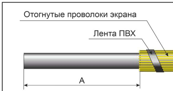
Вариант 2а. 1-я сторона кабеля с проволочным экраном
