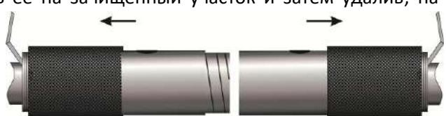
**2.2** Подготовить концы кабеля. Рабочее расстояние «X» в мм между срезами оболочек кабеля для каждого типоразмера муфт указано ниже.
